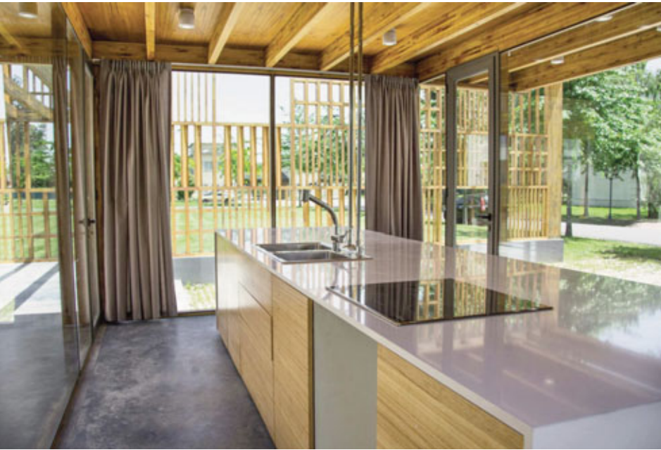
“Solamente hay tres hojas batientes, que son las que permiten la ventilación. Las caras que dan al este y al oeste sí son totalmente en aluminio y permiten 100 por ciento de ventilación cruzada”, explicó el arquitecto Fernando Robles.
