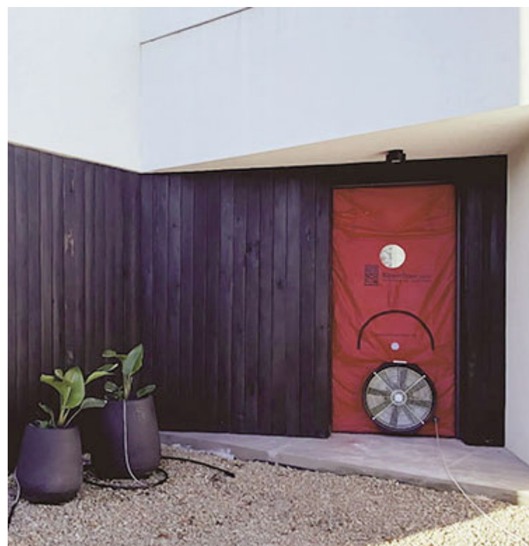
Prueba de control de calidad en Cardales por medio del "Blower Door Test". Se busca garantizar una construcción duradera, eficiente y libre de problemas de humedad y condensación.
