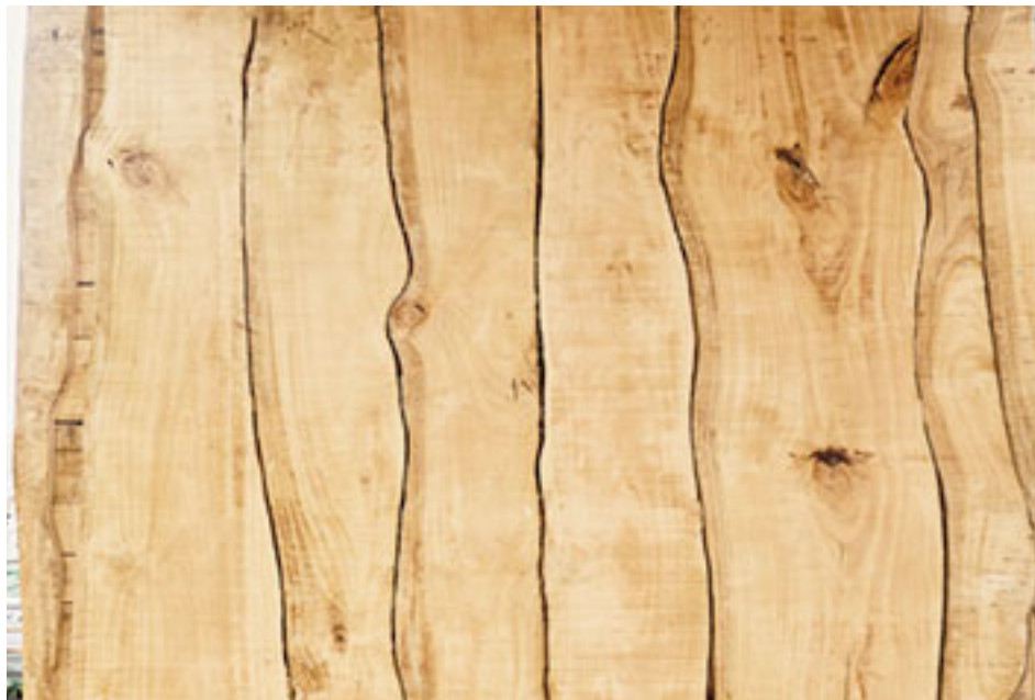
La innovación de A.I. Timber consistió en utilizar el propio contorno natural de las piezas para reducir los desperdicios y no segmentar las fibras de la madera.
