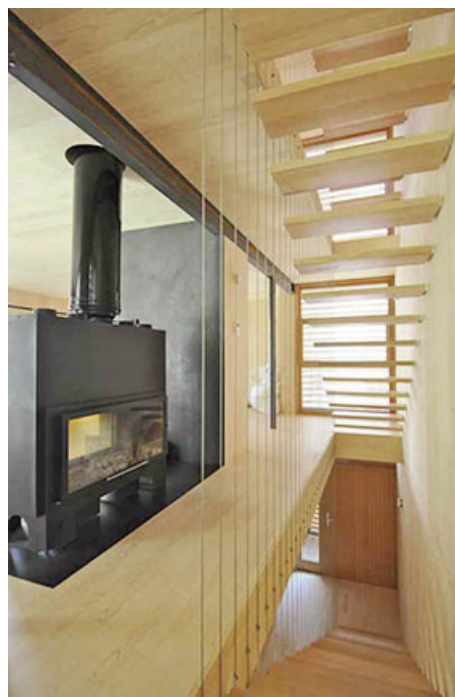
La madera laminada se utiliza para las paredes, tabiques y los pisos. Es un material cuyas propiedades se asemejan a las de hormigón armado, excepto que se pueden montar de una manera puramente mecánica, en "seco".
