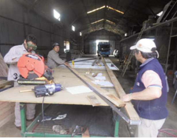
Preparación de una cercha en taller.
