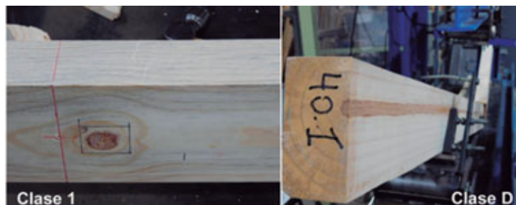
Figura 3. Tablas de pino ponderosa de la mejor calidad estructural y de calidad no estructural. La tabla de clase 1 tiene nudos individuales menores a 1/3 del ancho de su cara, mientras que en la tabla de la clase D se observa la presencia de médula y los anillos de crecimiento de gran grosor.
