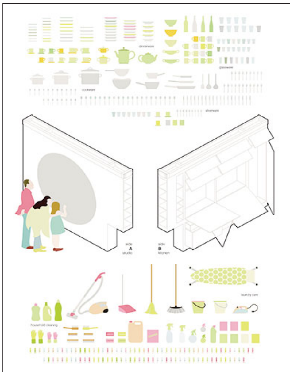
A través de un cuidadoso diseño, con el uso de un sencillo sistema de guías industriales, se organiza todo el espacio servidor de la casa. Se hace mediante tres contenedores de madera OSB suspendidos, móviles y transformables.
