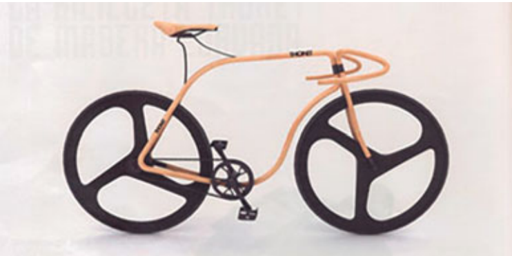
Andy Martin, arquitecto y diseñador londinense, recibió a finales de 2010 el encargo de Thonet para desarrollar una bicicleta siguiendo los sistemas artesanales de curvado de la madera de haya utilizados por Thonet en sus muebles de los años 1930.
