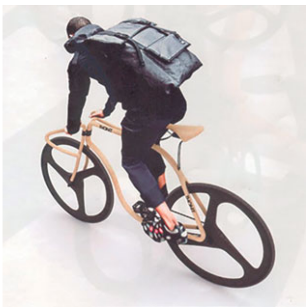
En la fabricación se utilizó perfil de madera de haya maciza de sección circular, que fueron curvados al vapor.
