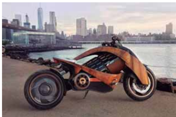
Moto eléctrica EV-1 de Newron Motors, con diseño en madera. Cuenta con una batería que le brinda una autonomía de hasta 300 kilómetros y se puede recargar el 80 por ciento en 40 minutos.
