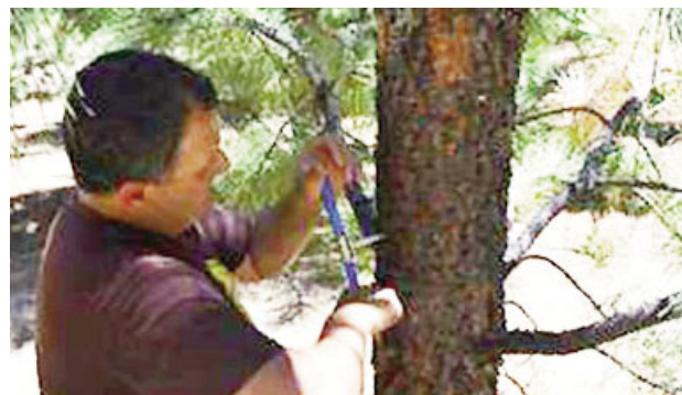
Extracción de tarugo de madera para cálculo de densidad
