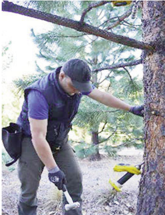
Medición de velocidad de propagación de onda acústica sobre el fuste con equipo portátil ST300 (Fibre-Gen, NZ).
