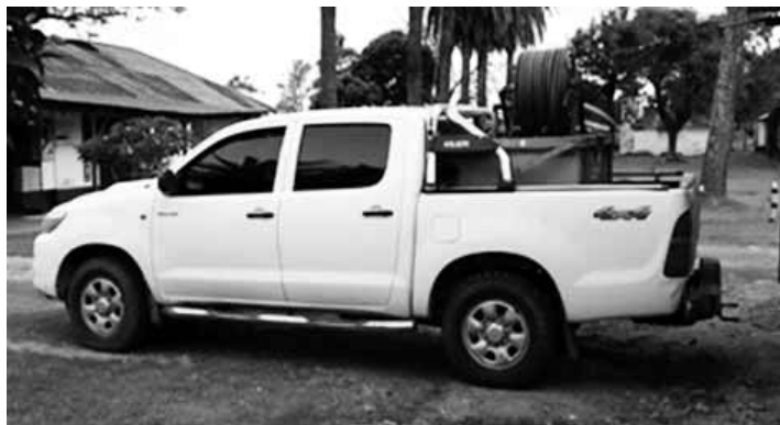
Pick up 4x4 con firechief (tanque de 600 litros, motobomba y carretel con 70 metros de manguera).
