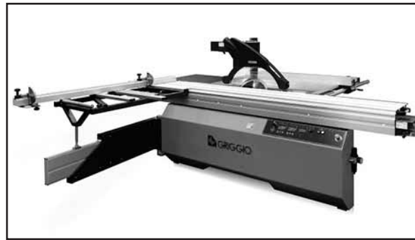
El primer premio en la categoría "Operación primaria y procesamiento de la madera sólida" fue para "Única Segura", un sistema de retracción de cuchilla con un tiempo de reacción de 5 milisegundos.
