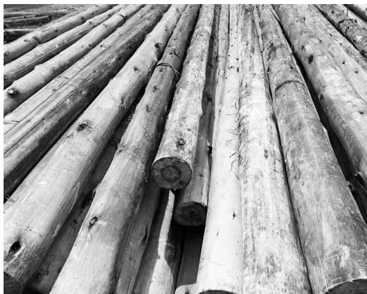
Postes impregnados de eucalipto.
