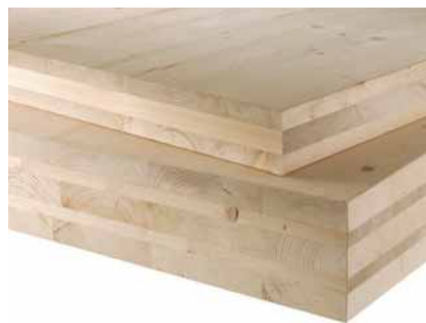
Los paneles monocapa son encolados y entrecruzados por lo menos en tres estratos para conseguir el CLT final.
